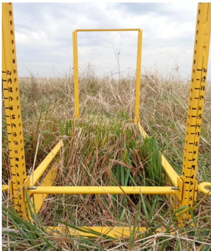
**Figura 9.** Estructura metálica para corte de dos o más estratos de forraje en forma precisa.
